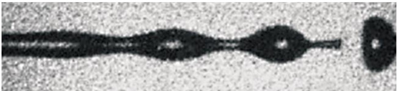
1. LAS INESTABILIDADES VARICOSAS terminan por romper en gotas este chorro capilar líquido de 400 micras de diámetro (superposición de imágenes obtenidas con luz estroboscópica).
