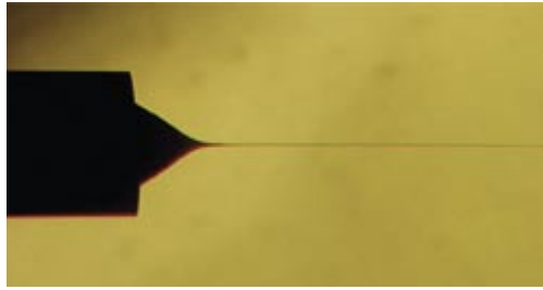
2. LA VISCOSIDAD aumenta la estabilidad de un chorro y, por tanto, la longitud que alcanza sin romperse. En la imagen, el chorro de agua (b) se atomiza mucho antes que el de glicerina (a), más viscoso y, por tanto, más estable y más largo.
