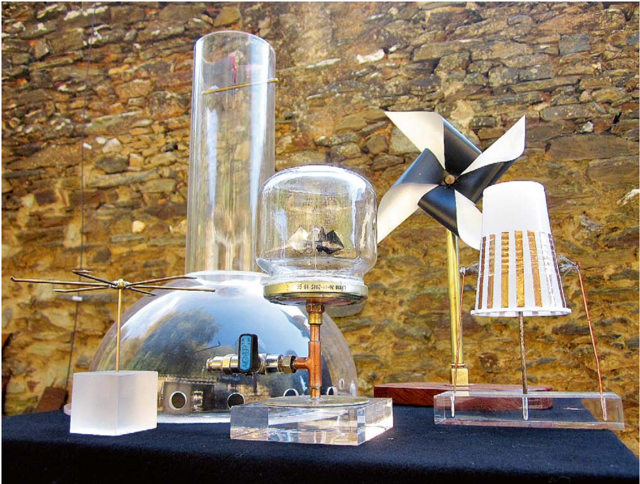
LOS CINCO MOTORES cuya construcción y funcionamiento se describen en este artículo. De izquierda a derecha: molinete electrostático, torre termosolar, radiómetro de Crookes, molinillo de viento y motor de Franklin.
