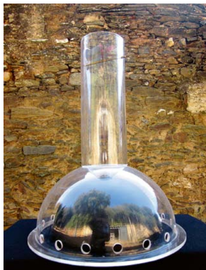
TORRE TERMOSOLAR: El aire caliente asciende por el interior del tubo y acciona un diminuto rotor. La clave de su buen funcionamiento reside en el bajo rozamiento del buje: un pequeño dedal de vidrio apoyado sobre una fina aguja. Abajo detalle del rotor y del eje de giro.
