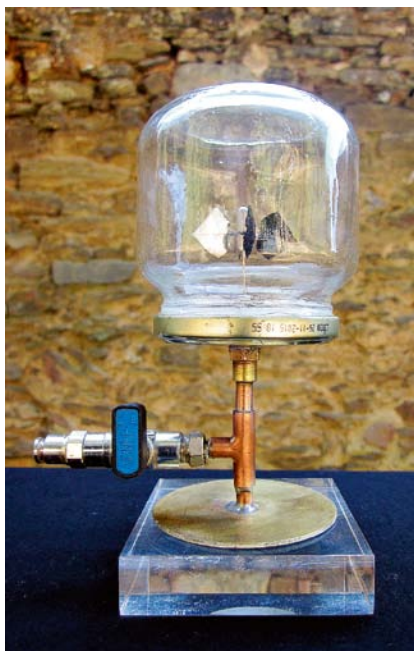
RADIÓMETRO DE CROOKES: Uno de los motores mínimos más difíciles de construir. El que mostramos aquí ha sido instalado en el interior de un tarro de mermelada en el que previamente se ha hecho el vacío. Abajo, líneas de corte para la fabricación del rotor (esquema superior) y detalle del dispositivo montado sobre su eje de giro (inferior).
