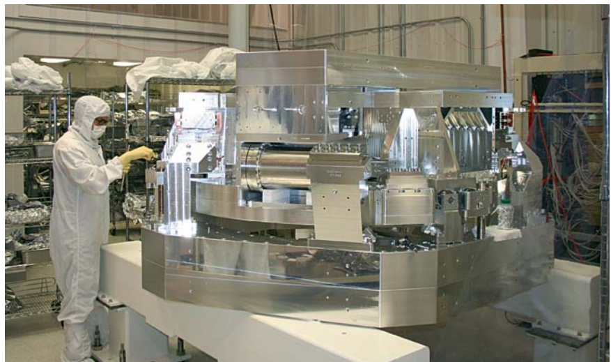
SISTEMA del que cuelgan las cuatro etapas de suspensión en péndulo (fotografía) y su posición dentro del conjunto de aislamiento (esquema, violeta).
