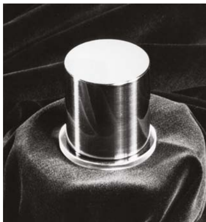
EL KILOGRAMO n.º 20, en EE.UU., es uno de los prototipos nacionales del patrón original.
