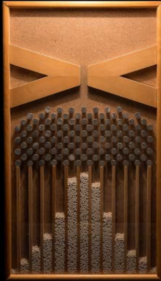
LA MÁQUINA DE GALTON. El movimiento aleatorio de las bolas al caer entre las clavijas conduce a una distribución normal en la parte inferior.
