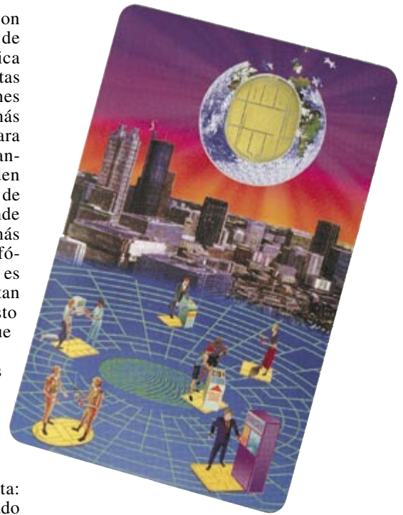
2 . L A S TARJETAS VERSÁTILES están dotadas de memoria y de un microprocesador alojado bajo los contactos dorados. La posición de los contactos está normalizada, a fin de que tarjetas y equipos de lectura de muy diversas procedencias puedan operar conjuntamente.
