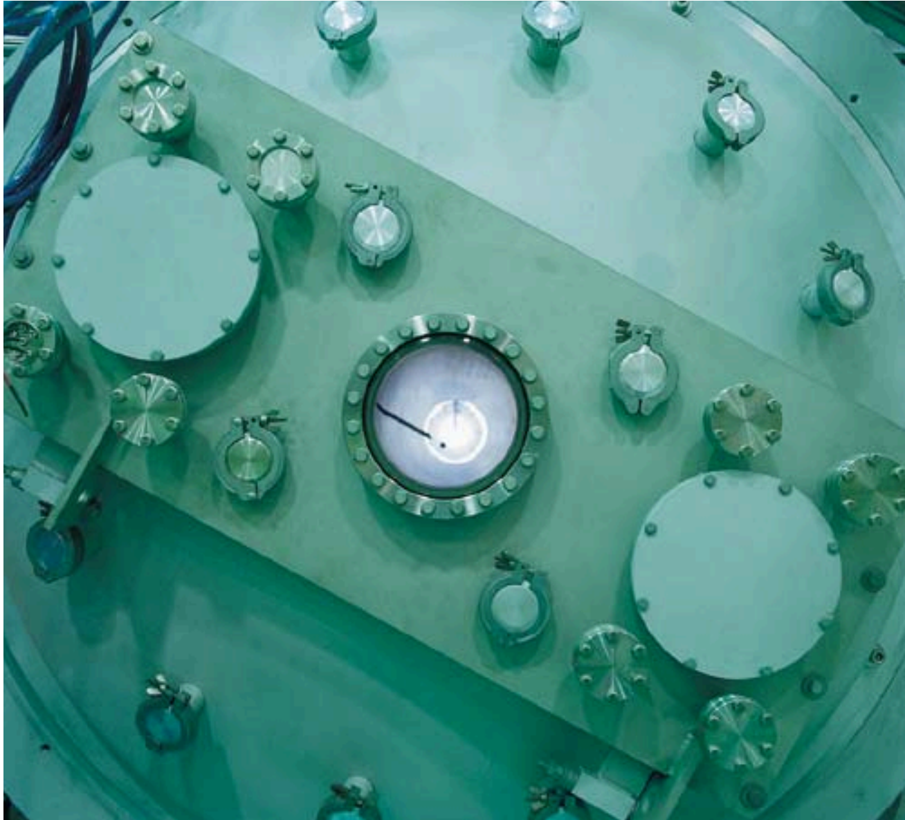
6. MIRANDO por el centro del cohete, se ve el plasma viniendo directamente hacia el observador. La ventana tiene un diámetro de 15 centímetros.
