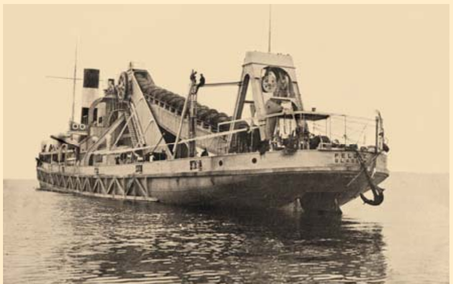
MAQUINAS CONTRA EL FANGO. Una enorme draga de cangilones para el Canal de Suez, 1909.
