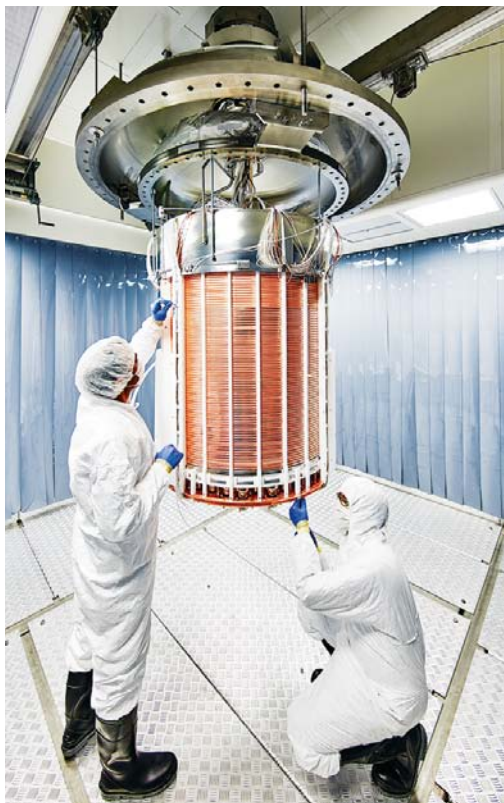
DOS TÉCNICOS trabajan en la Cámara de Proyección Temporal, la cual contiene xenón y se encuentra circundada con cobre para someterla a un campo magnético uniforme.
