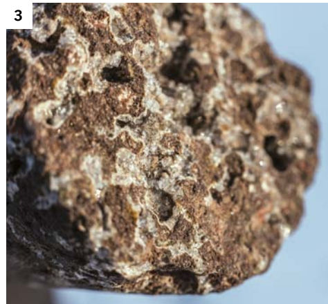
UNA MÁQUINA de la compañía Climeworks extrae dióxido de carbono de la atmósfera (1). Dentro de una cúpula cercana, un inyector (2) envía el gas a más de 700 metros de profundidad, donde al reaccionar con el sustrato forma carbonato, visible como vetas blancas en la muestra fotografiada (3).
