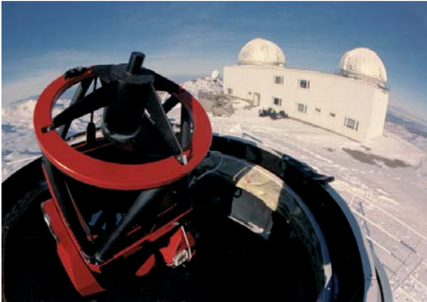
El telescopio de 60 cm BOOTES-IR, situado en el Observatorio de Sierra Nevada (IAA-CSIC). Una vez ha recibido una alerta de GRB, gira a una velocidad de 20 grados al segundo hacia la posición del cielo en que se haya producido la radiación, cuando la posluminiscencia es todavía brillantísima.
