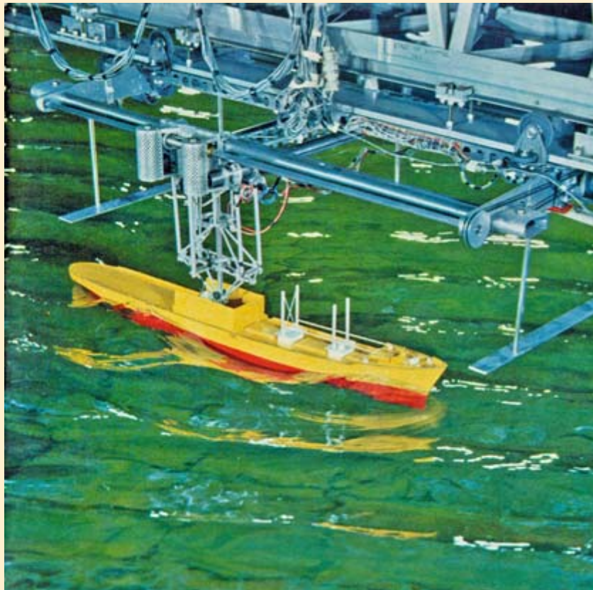
MAQUETA DE UN BARCO, de un metro y medio de longitud, ensayada en un tanque de olas, 1959.
